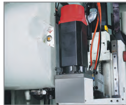
▶ 直結式主軸 1,5000 rpm 主軸馬力 2.2/1.5 kW
