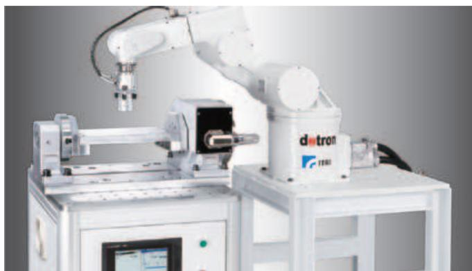
▲ 一次裝夾完成多面加工，進而與自動化機械手臂整合，為工業4.0的基礎設施預做準備。
