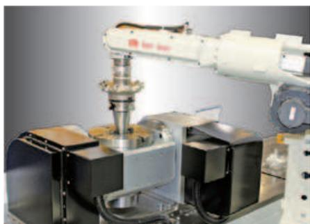
▲ 轉台內部裝置BT50拉刀機構，可夾持BT50刀柄加工，也可搭配機械手臂與工件倉庫，延伸成為FMS彈性製造系統。
