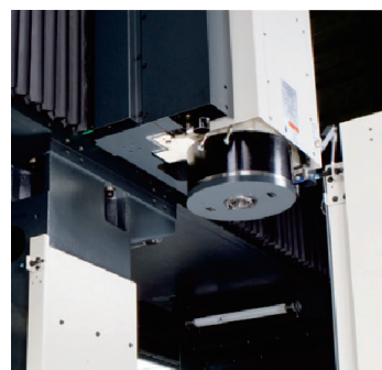
獨立頭倉設計，置放設計緩衝結構，可依配置增減庫位。
