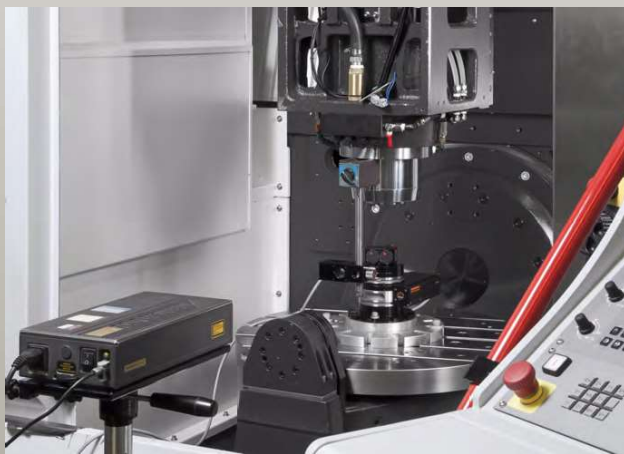
旋轉軸雷射精度檢測
